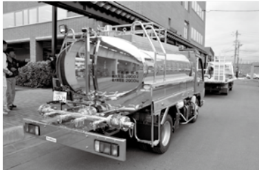
車 両 3トディーゼル車 2999cc タンク容量 2900ℓ 加圧ポンプ、給水栓4、放送設備を装備
