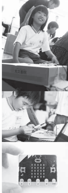
マイクロビット (micro:bit) プログラミングで操れる小さなコンピューター。25個のLED、2個のボタンスイッチのほか、無線通信機能などがついています。
