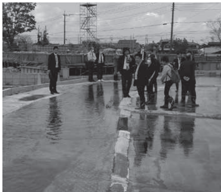
遊水地の水理模型に水を流し実験する様子
