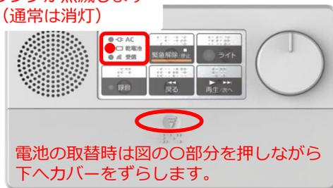
電池の取替時は図の○部分を押しながら下へカバーをずらします。
