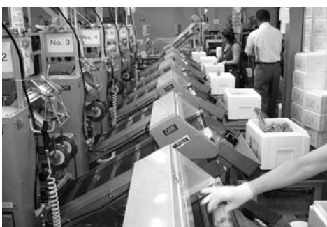
施設内部の自動結束機ロボット
