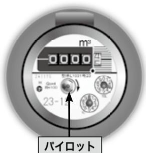
冬期間は水道メーターの検針ができません。そのため、漏水に気づかなかつたり、水道管が凍結破損してしまつたりする場合があります。雪が多く積もる前に漏水などの点検をお願いします。蛇口を閉めた状態で水道メーターのパイロットを確認してください。パイロットが回ってれば漏水していますので、水道指定工事店へ連絡し修理をお願いします。
